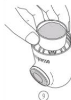
9. Introduceți elementul de filtrare înapoi în Minipresso-ul GR .
