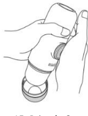
15. Primele 6 prese creează presiunea corectă. Pompați încet până când cafeaua începe să curgă
